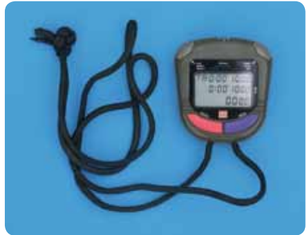
Tidtagarur, inköpt hos Globalsport ( www.globalsport.se ). Det är ett tidtagarur med 3 raders display som simultant visar rullande tid, mellantid och tid/varv.
